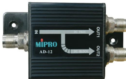
Mit dem passiven 2-Kanal Antennen-Combiner / -Splitter AD 12 (2 in 1) können bis zu zwei Sendeeinheiten über eine einzelne Sendeanenne betrieben werden (Einsatz bei In-Ear Systemen). Dadurch werden Intermodulationsverzerrungen, „Rauschen“ und Signalaussetzer reduziert. Der AD-12 kann auch invers als Antennensplitter genutzt werden um mit einer Empfangsantenne zwei Empfängereingänge zu speisen.
